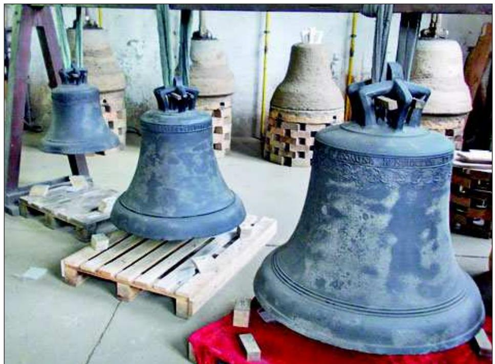
einzigste Lösung blieb nur noch die Konstruktion einer komplett neuen Krone für die mittlere Glocke. Und so geschah es dann auch: die Krone wurde geformt, in der zur Glocke passenden Bronzelegierung gefertigt und schließlich in die Marienglocke eingeschweißt. Diese unerwartete Mehrarbeit war letztlich der Hauptgrund für alle zeitlichen Verzögerungen.
